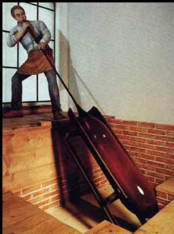
Fensterscheibenherstellung aus einem Glaszylinder im Zylinderblas- und -streckverfahren (Quelle: Glocker, 1992, S. 79)
