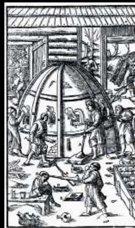
Darstellung eines mittelalterlichen Glasschmelzofens aus Georgius Agricolae „ De re metallica “, 1556, mit einer bienenwabenartigen Form und 3 Räumen, dem Feuerungs-, Schmelz- und Kühlraum (Quelle: Glocker, 1992, S. 17).
